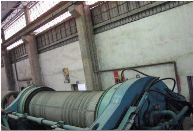
Thử áp lực ống | Pressure test of pipe
