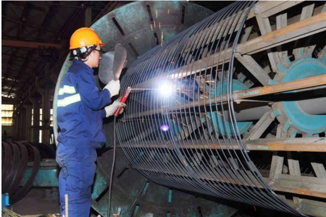
Tạo lồng thép - Steel cage making
