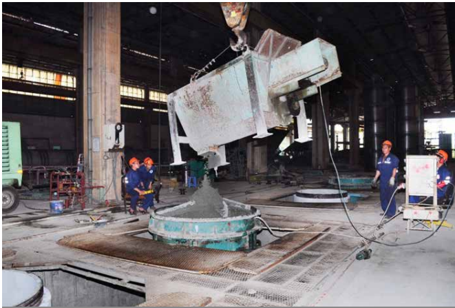
Đúc ống bằng phương pháp rung - Vertical vibration cast
