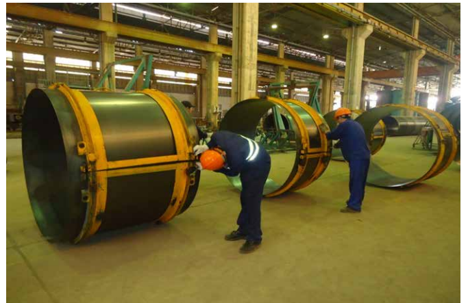
Tạo nòng thép - Steel cylinder making
