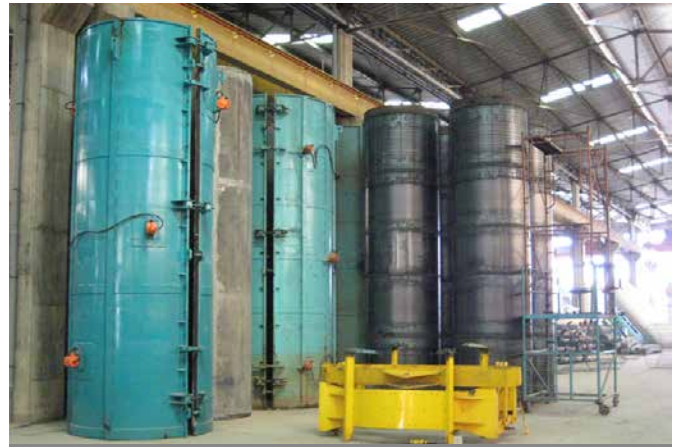
Nòng thép và khuôn đúc - Steel cylinders and moulds
